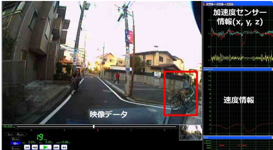
図：ヒヤリ・ハット判別に使用する時系列マルチモーダルデータ例
